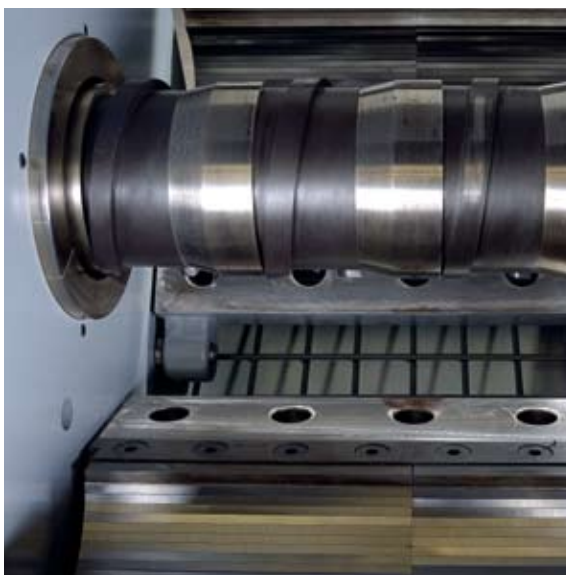
Einzelne Schnecken-segmente gewährleisten die genaue Einstellung der zu verpressenden Saat.
