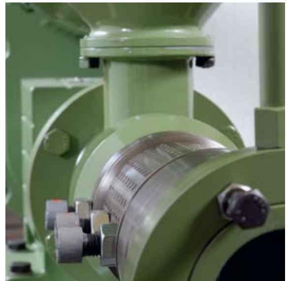
Mit der Poo20 werden die meisten Ölsaaten ohne Vorzerkleinerung und Vorwärmung verarbeitet, wodurch biologisch hochwertige Öle gewonnen werden.
