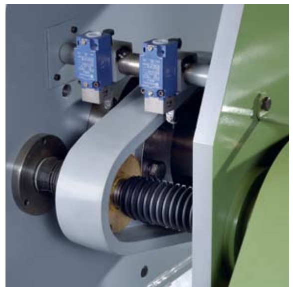
Der elektrisch ein- und ausfahrbare Druckkonus dient dem einfachen An- und Abfahren der Maschine sowie zur Druckregulierung.
