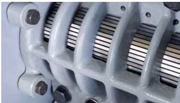
Seiherkorb einer Ölpresse mit hochverschleissfesten Ersatzteilen
